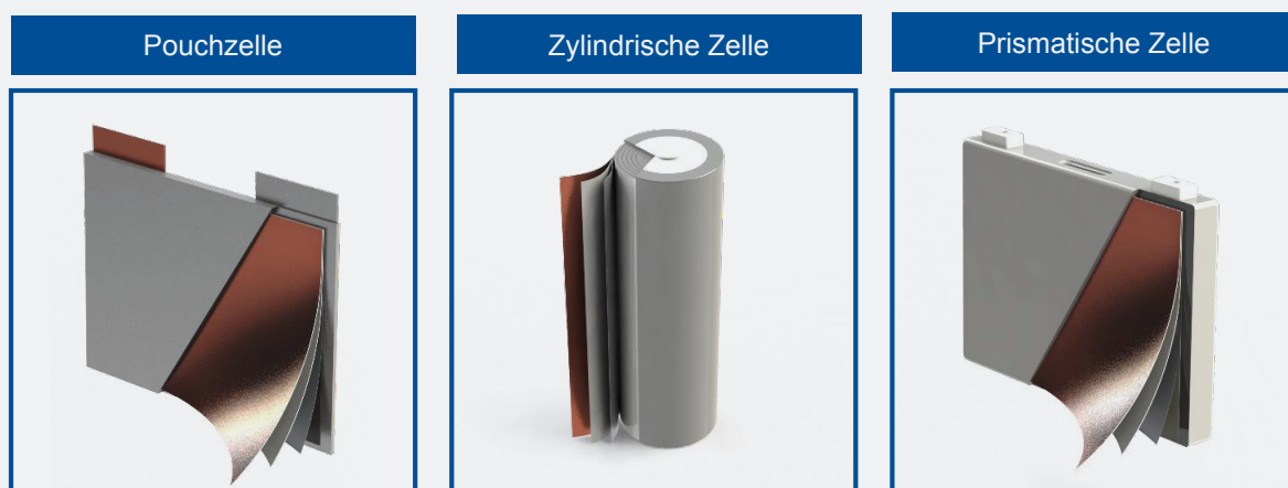
Abbildung 1-2: Gängige Zellformate (Bildquelle: PEM (RWTH Aachen))
